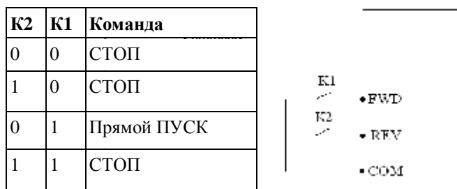
Рисунок 6-12: 2-проводной режим управления 2 типа
