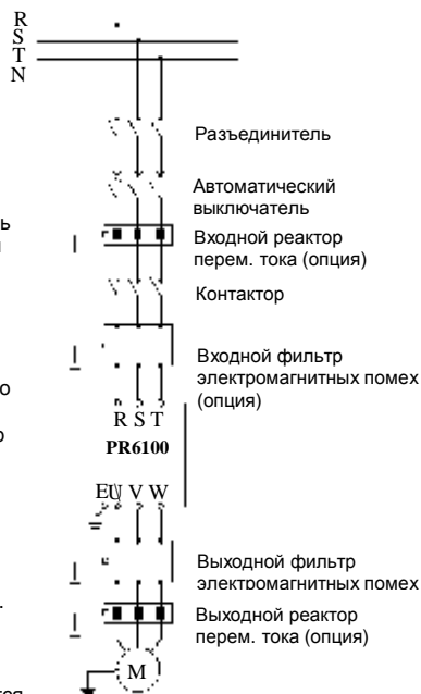
Рисунок 3-4. Присоединение преобразователя и дополнительного оборудования
